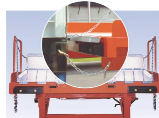
차량과 Dock 연결시 충돌에 의한 충격흡수 및 파손 방지를 위해 2개의 고무 범퍼가 설치되어 있으며, 차량과 Dock의 이탈 방지를 위한 안전 고리가 측면에 설치되어 있습니다.
