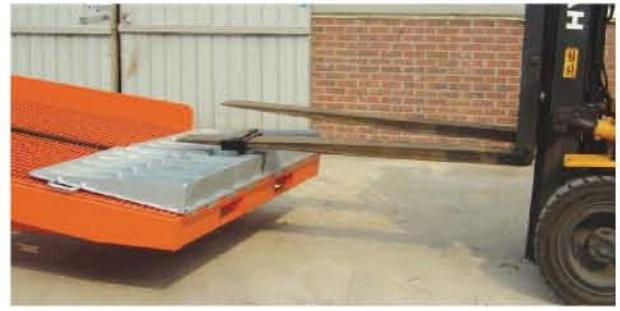
**포크 Hole에 의한 이동방식 (Mobile Type By Fork-Hole)**
